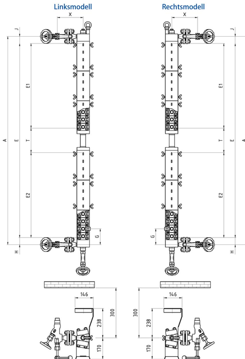
Bei einer Schaulänge  $E > 800$  mm entfällt ein Bullauge und es entsteht ein Totraum  $T = 100$  mm.
